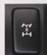
電動センターデフロックスイッチ<VSC-アクティブTRCシステム付車>
