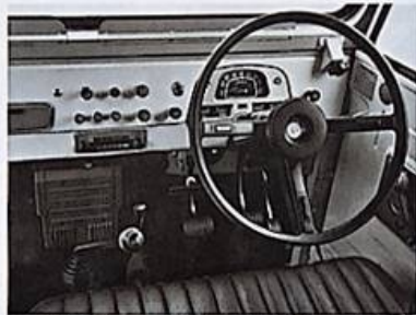
いちだんと豪華になった計器盤…40系の計器盤意匠を変更。ステアリングはFJ55Vと同じデザインです。(2段折)
