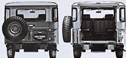
三方開き式リアゲート…FJ40Vのリアゲートは、ウィンドウ部分は上方へ、そして下部は左右に開く、便利で使いやすい三方開き式。
