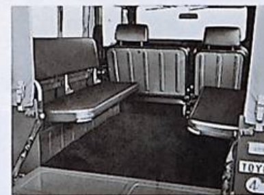
FJ43のリアシート…左右にそれぞれ3人掛けのシート。前席と合わせて計8人乗り。広く合理的なシートのレイアウトです。
