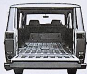
パワーリヤゲート…リアウィンドウは電動式運転席からリモコンコントロールが出来ます。
