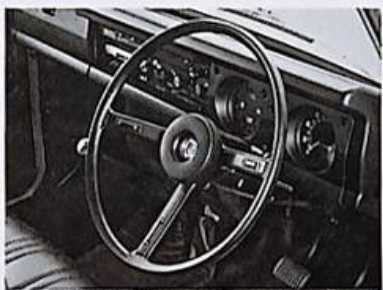
機能美にあふれた計器類…厚いワッドで覆われたダッシュボード、スイッチ類は識別のラクな絵表示式。運転は3段フロア式です。
