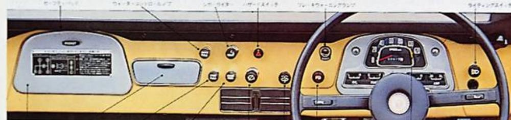
セーフティーパッド—安全対策のひとつ。F.D.スイッチ—駆動方式を変える電磁式
