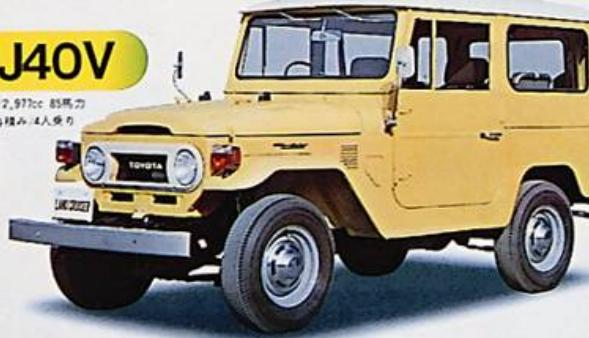
積荷を大切に、スピーディに運ぶ——ランドクルーザーBJ40Vがピッタリです。ボンネットは堅ろうそのもの、保温性もじゅうぶんです。ショックアブソーバー用の前・後揃えサスペンションは車軸式、大型車のみの横子型フレーム採用…と過酷走行に耐える強じんな足わりを自信です。さらに前座フロアにマット(厚さ5mm)、また3点式エンジンマウンティング実用…と駆動・騒音対策を施しました。ピジネスに…レジャーに…幅広くお使いいただける車です。
