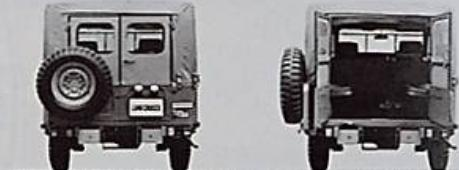
リヤゲート…FJ40・43のリヤゲートは、側とその下のゲートが、いずれも左右に大きく開く観音式を採用。スペアタイヤはリヤゲートに装置。
