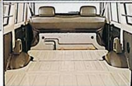
FJ56V。フロントシートは身体にフィットする発泡レザーのシート。リヤシートは前に倒すと平らな荷台に早変わり。
